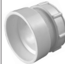
Parte No. PVC 103 R Adaptador Trampa - Macho Con Tuerca Plástica y Arandela de 1½'' para ajustar a trampas de 1½'' y 1¼'' (Cem DWV x Deslizante Tubular, con Tuerca Plástica)
